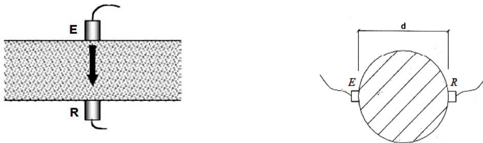
Рисунок 2 – Техника прямой ультразвуковой передачи, когда передатчик и приемник коаксиально расположены на двух противоположных сторонах бетонного элемента
