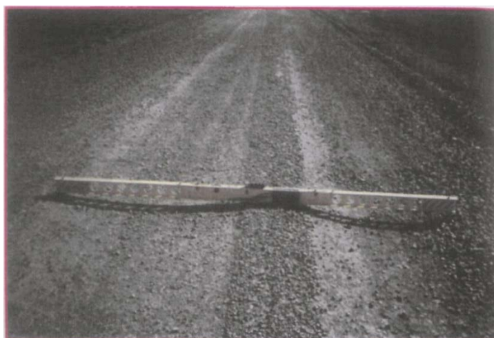
Figura 78 – Măsurarea făgașelor pe îmbrăcăminți de tip tranzitoriu
